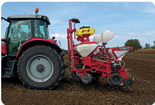
Második mikrogranulátum-szóró adapterrel felszerelt vetőgépek
