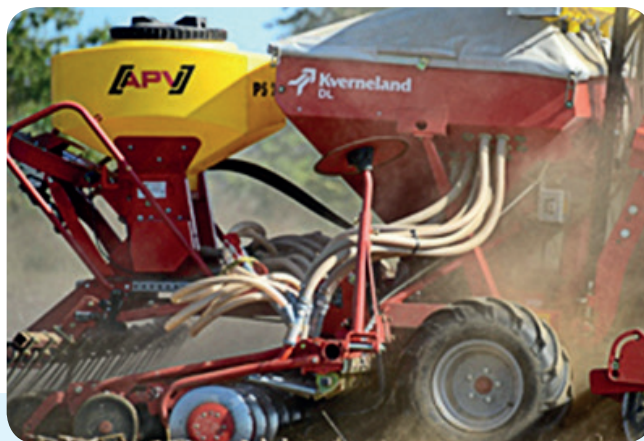
Második mikrogranulátum-szóró adapterrel felszerelt vetőgépek
